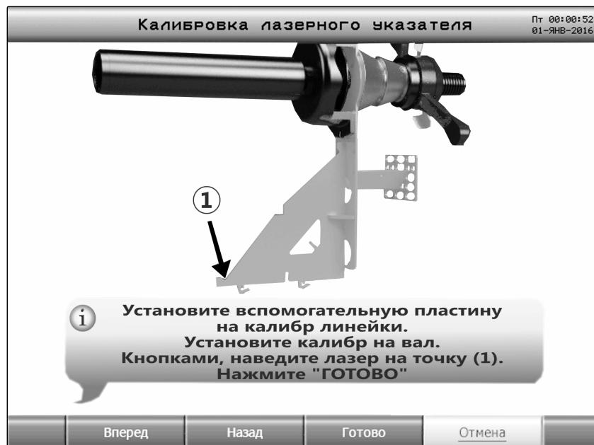
Рисунок 8.7 – Окно калибровки лазерного указателя
