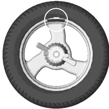
б - груз установлен в положение «12 часов»
