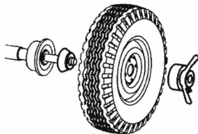
Рисунок 6.9 – Установка колеса
