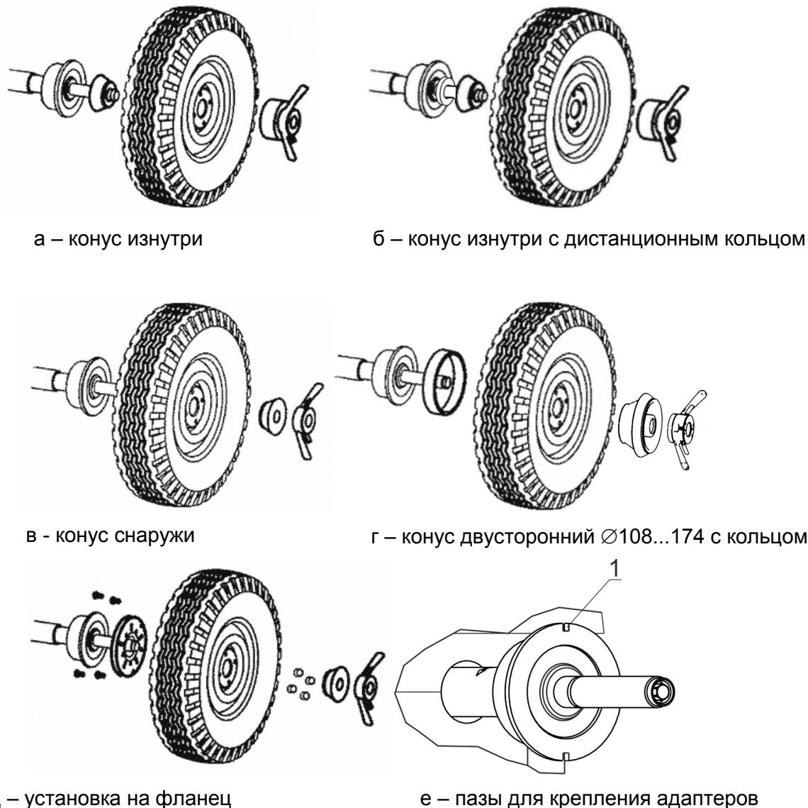
Рисунок 5.1 – Установка колеса
