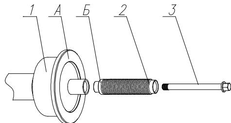
1 - шпиндель станка; 2 – вал; 3 – болт
