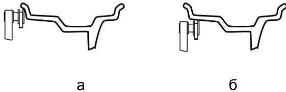
Рисунок 5.2 – Подвод линейки при первом измерении
