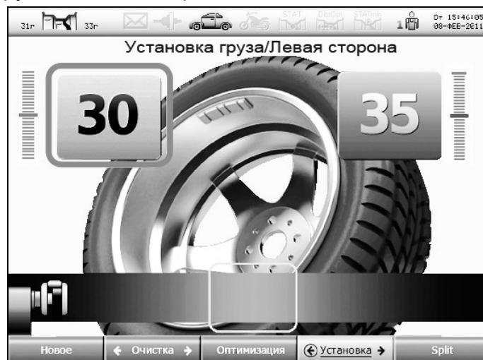
Рисунок 5.12 – Экран при установке груза линейкой
