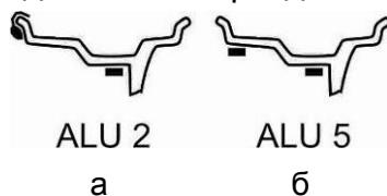
Рисунок 7.1 – Допустимые схемы установки грузов для режима Split
