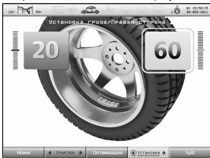
Рисунок 5.14 - Установка в «6 часов» справа
