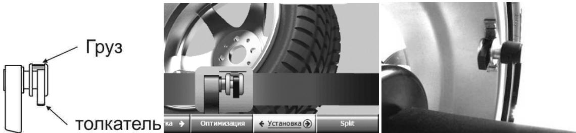
Рисунок 5.13 – Установка груза линейкой
