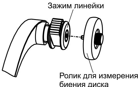
Рисунок 7.5 – Ролик для измерения биений
